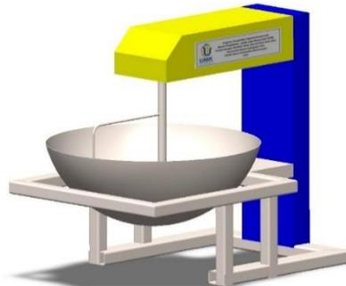
**Gambar 4.** Desain alat penggoreng abon sistem mekanis
