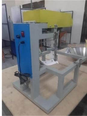
**Gambar 5.** Perakitan alat penggoreng abon sistem mekanis
